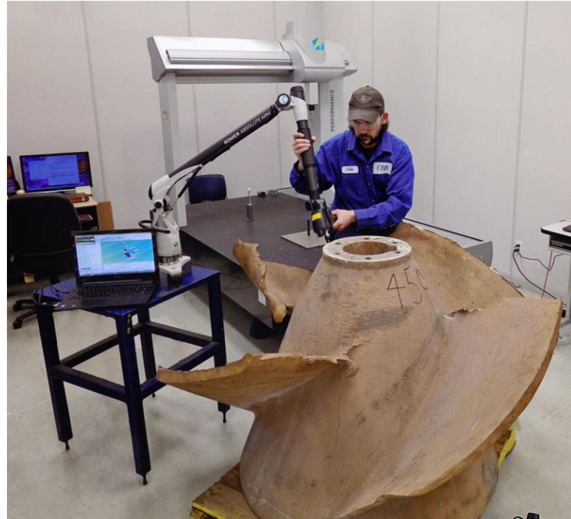
Nous pouvons également effectuer un reverse engineering de pièces moulées existantes ou de modèles usés avec notre CMM portable à 7 axes avec un scanner laser intégré, fournissant des données 2D et 3D
